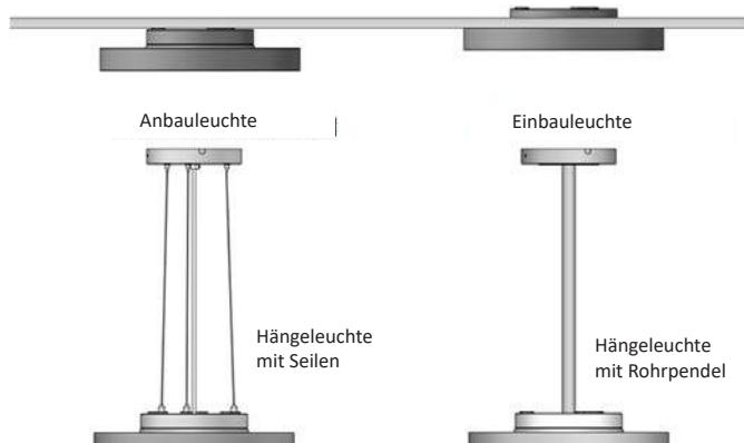
ausgezeichnetes Wärmemanagement. Die Leuchten sind mit Durchmesser 300 mm, 400 mm, 500 mm, 600 mm, 800 mm und 1000 mm verfügbar.
