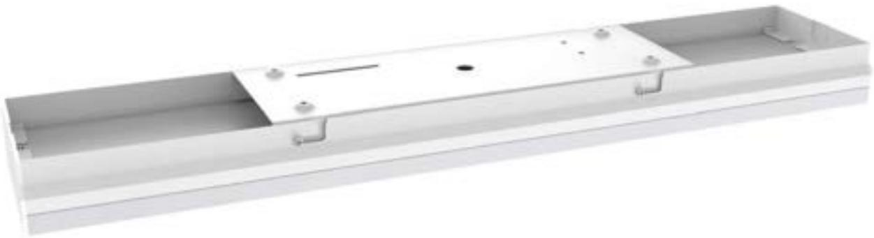
Die Balkenleuchte BARRA 120 ist sehr einfach zu montieren. Die Grundplatte aus Edelstahl wird an die Decke montiert und die Leuchte mit dem Bayonettschlüssel in die Grundplatte eingeschoben. Daselbe gilt natürlich für die Seilaufhängung. Die Seile werden an die Grundplatte angeschraubt und die Leuchte eingehängt.
